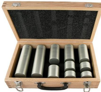
**Figura 2.2.2.1** Set estándar de bloques de distancia/área amplitud.
