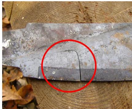
Tal y como se observa en la figura anterior el componente tiene una grieta que no tiene una sola dirección. Por lo tanto, para poder detectar toda la extensión de esta grieta se debería magnetizar en dos sentidos, esto se puede apreciar en la siguiente figura.
