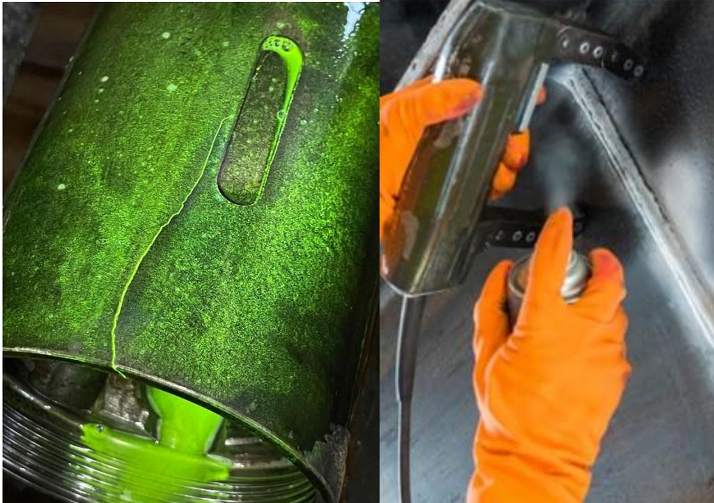
Tal y como se aprecia en la figura anterior ambos casos logran detectar con claridad la discontinuidad pero la técnica fluorescente brinda una ventaja evidente con respecto a la sensibilidad. La fluorescencia le facilita al técnico inspector realizar una inspección visual mucho más efectiva además de brindar mayor sensibilidad para detectar discontinuidades pequeñas.
