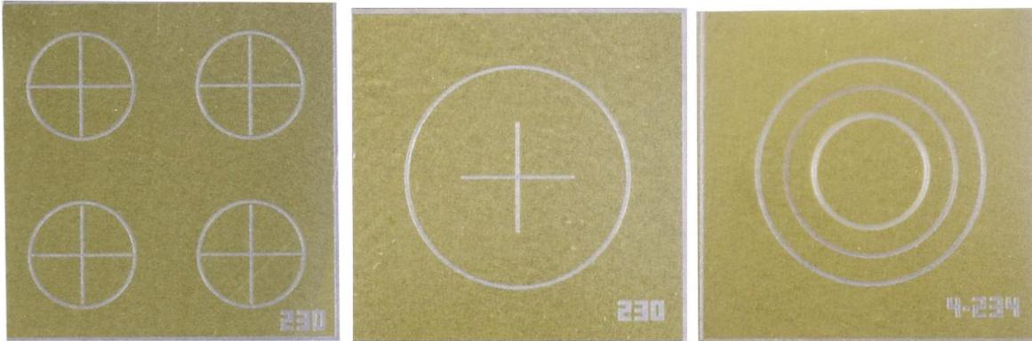
Tal y como se aprecia en la figura anterior podemos observar que existen distintos tipos de QCI. En su superficie tiene discontinuidades artificiales para generar una indicación en función del sentido de la magnetización.
