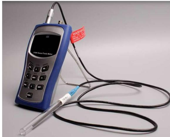
Tal y como se aprecia en la figura anterior el gaussímetro digital tiene una sonda. A diferencia del gaussímetro analógico este equipo toma la lectura mediante la colocación de la sonda en la zona de interés, brindando ciertas ventajas en referencia a la implementación.
