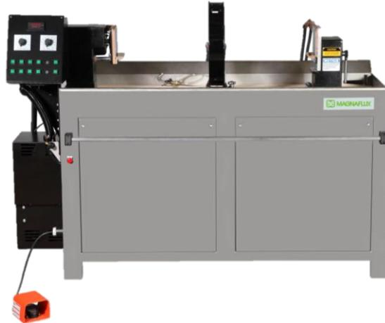
Tal y como se aprecia en la figura anterior, el banco horizontal posee una bobina movable y puntos de contacto movibles para adaptarse a la configuración del componente a evaluar.
