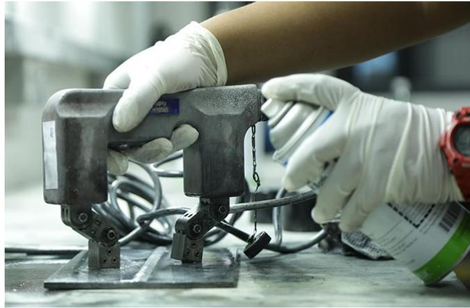
En la figura anterior se aprecia la inspección de partículas magnéticas en donde se utiliza un yugo electromagnético para generar un campo magnético en la pieza evaluada.
