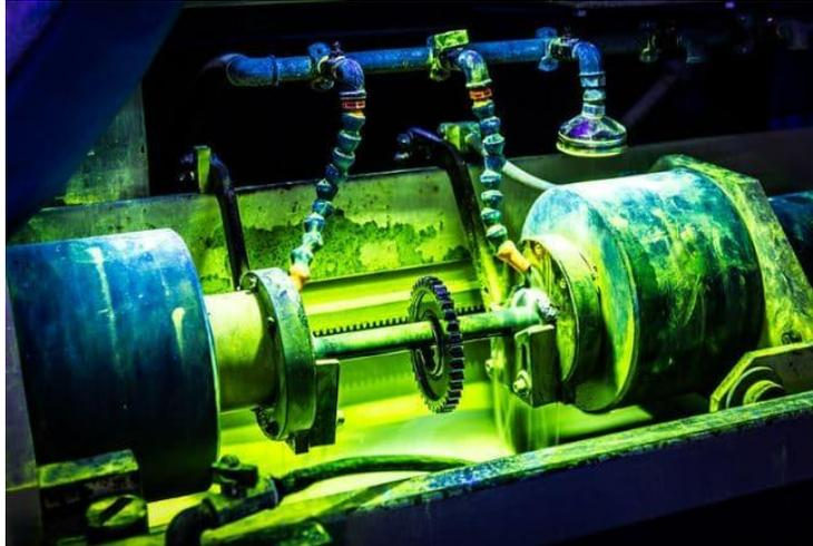
Tal y como se observa en la imagen, se tiene un componente que está siendo magnetizado circularmente mediante una inducción indirecta.
