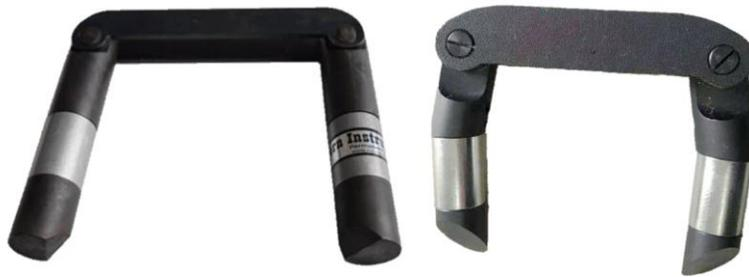
En la figura anterior podemos observar dos yugos electromagnéticos, simplemente observando la imagen podemos apreciar el gran beneficio que brinda trabajar con un imán permanente, siendo este la carencia de una fuente eléctrica. Esto permite que el yugo de imán permanente tenga una portabilidad superior a las otras técnicas.
