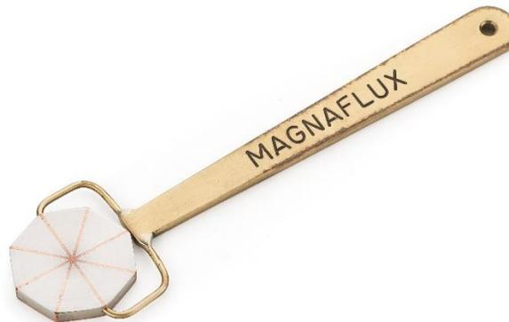
El componente que se aprecia en la figura anterior está elaborado por un material ferromagnético pero las líneas que se observan en el octágono son de un material diamagnético. Dichas líneas simulan discontinuidades que serán perpendiculares, paralelas y a 45° de la aplicación del campo magnético.
