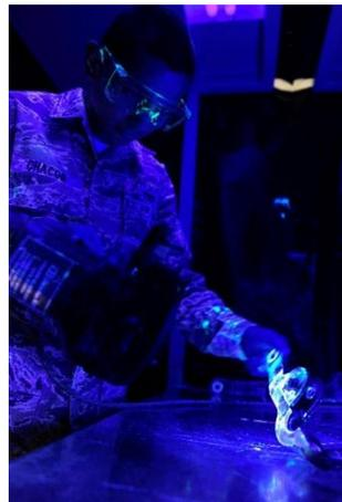
Dentro de la luz ultravioleta existen distintos tipos dependiendo de la longitud de onda, pero no hace falta evaluar todos los tipos sino solamente el implementado en partículas magnéticas. La luz ultravioleta implementada en este método es la Luz Ultravioleta “A”, que se puede abreviar como UVA.
