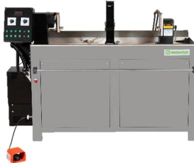
La figura anterior muestra un banco horizontal. Para este tipo de sistemas se debe tener un reservorio de la formulación de las partículas húmedas, el cual debe ser cuidadosamente preparado y mantenido, esto se verá más adelante.
