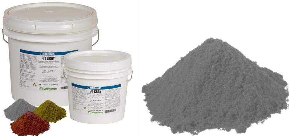
El color de las partículas no afecta en su magnetización y en su capacidad de detectar las discontinuidades pero si impactar en la capacidad el inspector de detectarlas en función del contraste que generen con el fondo. Suponiendo que una partícula roja se aplique sobre un componente de color rojo hará que sea difícil detectarlas para el inspector.
