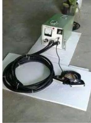
La longitud de los cables varía en función de la aplicación pero se puede hablar de un rango de 4m a 30m. Es importante recordar que a medida que el cable es más largo la fuerza de la magnetización disminuye, es por ello que para algunas aplicaciones se recomiendan cables cortos.
